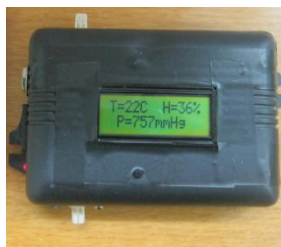
Рисунок 1 – Автоматизированный измеритель влажности, давления и температуры: принципиальная схема (а); экспериментальный образец (б).
